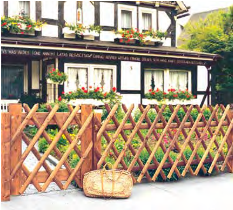
Jägerzaun aus kesseldruckimprägnierter Kiefer/Fichte, aus vorgefertigten Scherenfeldern, ohne Halbriegel, Nägel verzinkt, Latten Ø ca. 52 mm, in den Höhen 80, 100, 120 und 150 cm erhältlich, z. B. Zaunfeld , 250 x 80 cm, Art.-Nr. H 2175593 | M 181416 | S 1444857
